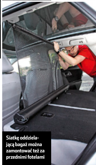
By złożyć oparcia kanapy, wystarczy pociągnąć za dźwignię w bagażniku
