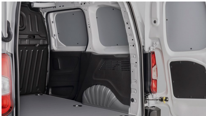
Wyłożenie ścian bocznych panelami z polipropylenu
